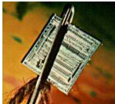
Figure 6. Microprocesseur F-100 D'une surface de 0,6 cm 2 , le microprocesseur F-100 est assez petit pour passer dans le chas d'une aiguille.
