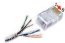
Connecteur RJ45 (2) Clip dessous
