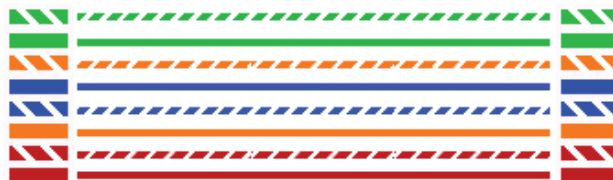
La Norme TIA/EIA 568-A Straight-through cable
